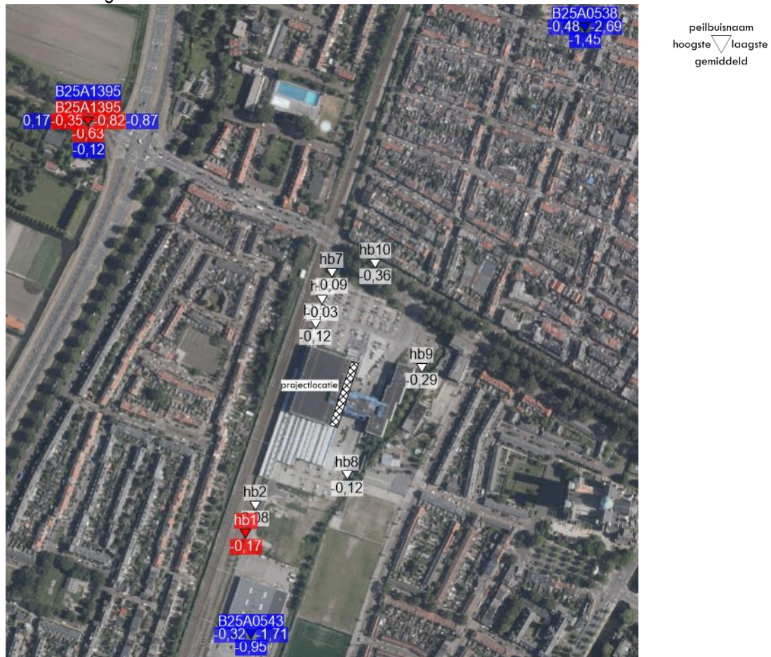
Figuur 2 - grondwaterstand t.o.v. NAP (wit = freatisch/watervoerende laag 1, rood = watervoerende laag 2, blauw = watervoerende laag 3)
